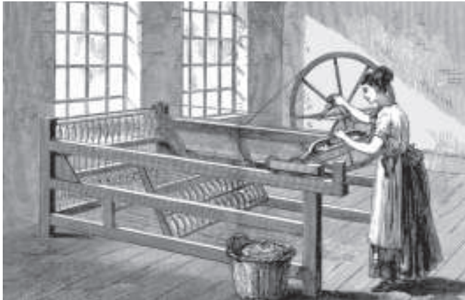
İplik eğirme makinesi İngiliz James Hargreaves tarafından icat edilmiştir
